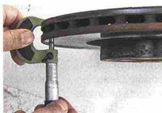
↑ I dischi anteriori vanno sostituiti, visto che lo spessore è inferiore al valore minimo consentito: è infatti pari a 19,02 mm contro i 20,2 ammissibili
